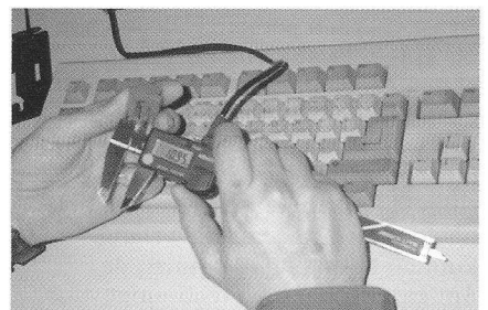
De gegevens die de schuifmaat inleest worden meteen verwerkt door de Amiga.
