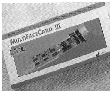
Het te kort aan seriële poorten werd opgelost met een Multiface III-kaart van AlfaData.
